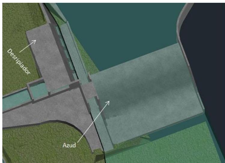
Figura 7.12. Isométrico de la estructura de captación de la PCH SOFÍA.
