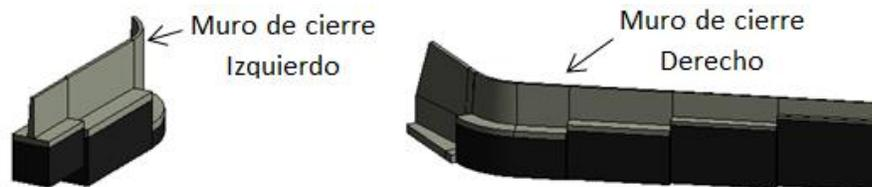
Figura 7.57. Vista tridimensional de los muros de cierre.
