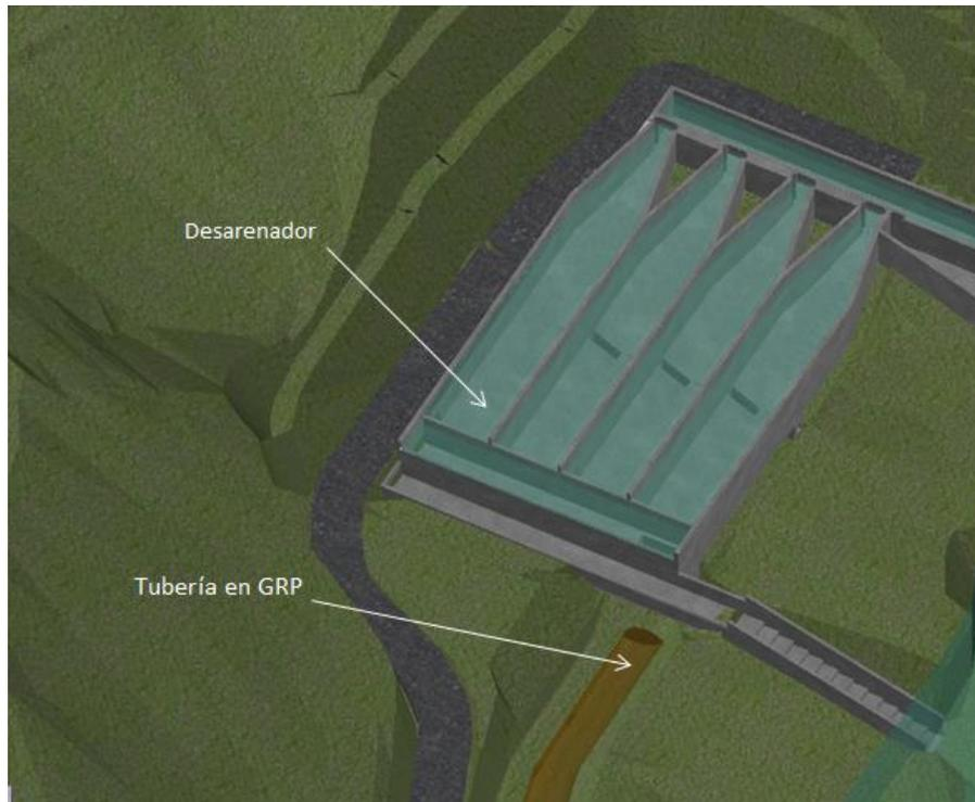
Figura 7.17. Isométrico del desarenador y el tanque de carga de la PCH SOFÍA.
