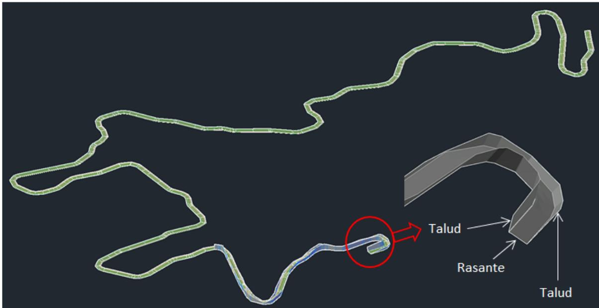
Figura 7.34. Corredor y superficie de la vía a la casa de máquinas.
