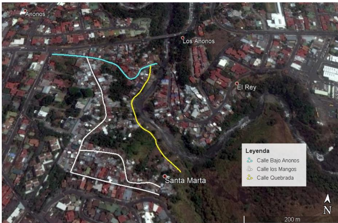
Figura A.4.7. Trazado de la tubería de alcantarillado libre de sólidos en la comunidad Bajo los Anonos.
