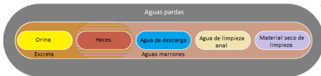
Figura 3.2 Definición de excreta, aguas marrones y aguas pardas. (Adaptado de Tilley et al., (2014))
