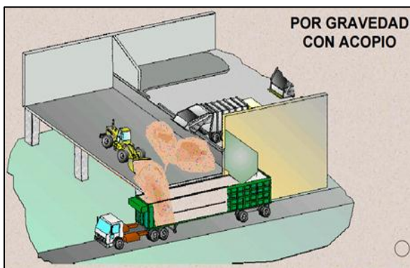
Figura 13 Estación de transferencia indirecta de residuos por descargue en foso cargue con maquinaria pesada Fuente: Fontan (2009)
