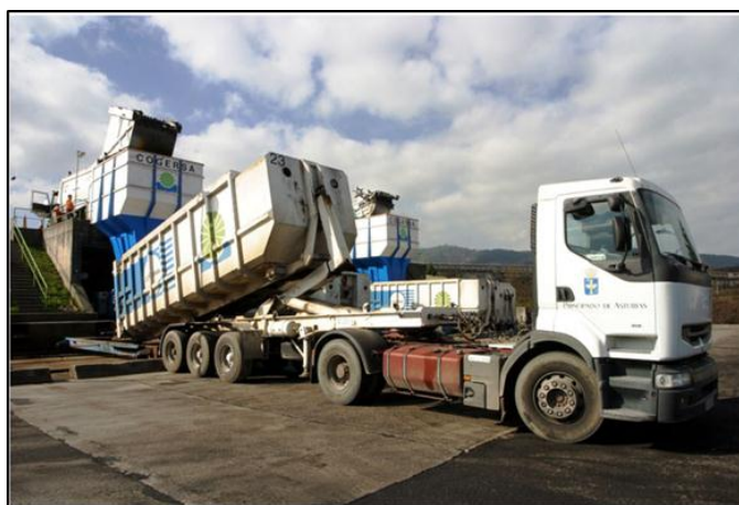
Figura 7 Estación de transferencia de residuos sólidos por tractocamiones en Belmonte (España) Fuente: COGERSA. (2017). Estación de transferencia de Belmonte. Recuperado de: http://www.cogersa.es
