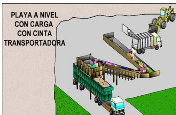
Figura 11 Estación de transferencia indirecta de residuos por descargue en foso cargue con cinta transportadora Fuente: Fontan (2009)
