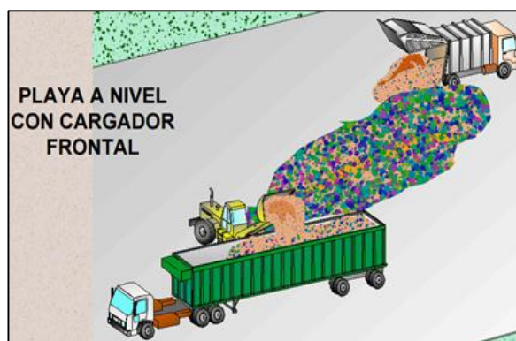
Figura 12 Estación de transferencia indirecta de residuos por descargue en playa y cargue con maquinaria pesada Fuente: Fontan (2009)
