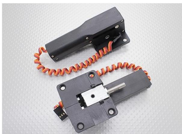
Figura 13. Servomotores tren de aterrizaje
