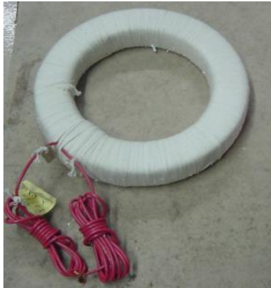
Imagen 17. Transformador de corriente tipo bushing.
