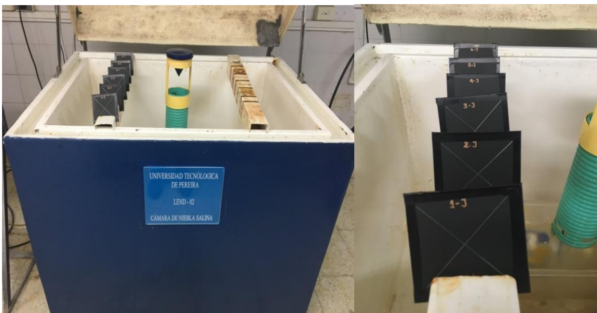
Figura 5. Disposición de las probetas en cámara de niebla salina
