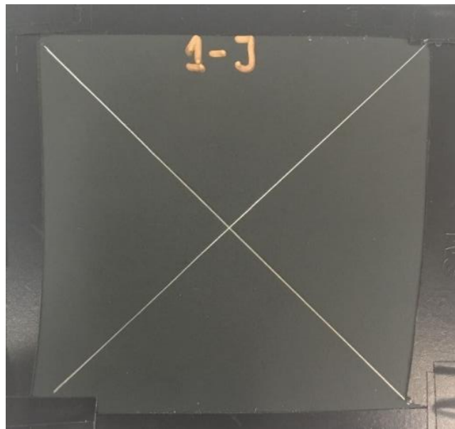
Figura 3. Concentrador sobre la superficie, corte en equis (X)
