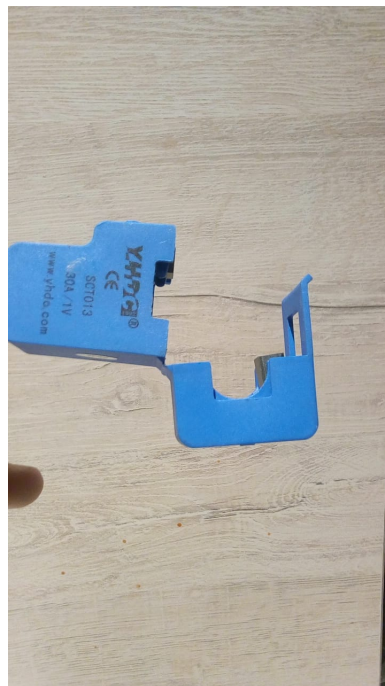
Imagen 3.1.c Transformador de Corriente no invasivo de núcleo partido
