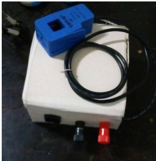
Imagen 3.1.a de dispositivo de transformación y acondicionamiento correspondiente a la Etapa 1
