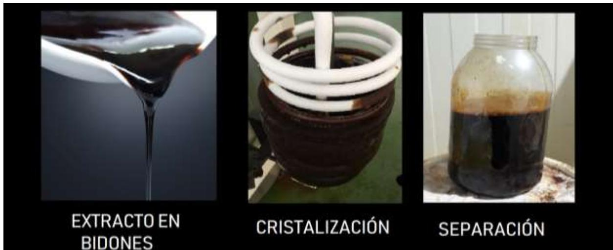
Figura 3. Concentración en bloque con serpentín
