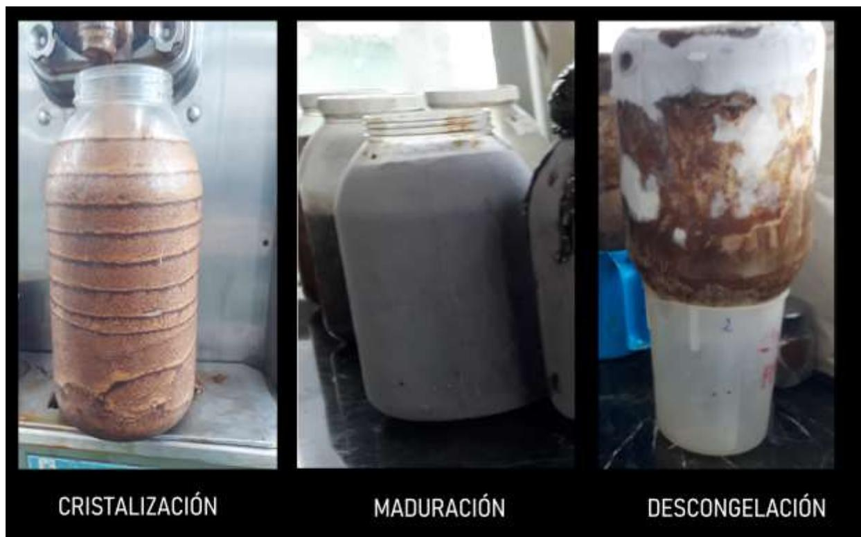
Figura 2. Proceso de la tarromaquia con granizadora.
