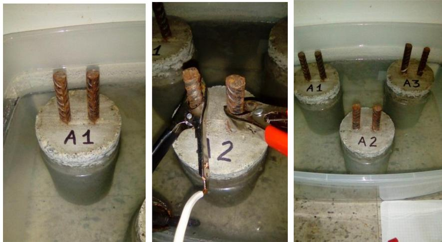
Figura 20 Resultado final de probetas sumergidas en agua
