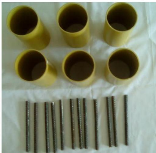
**Figura 9** Moldes para la elaboración de los especímenes
