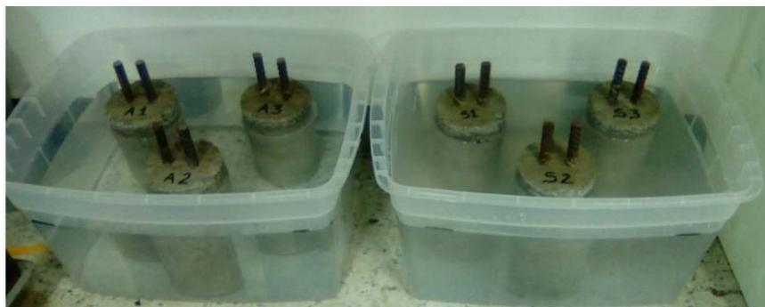
**Figura 11** Adecuación de los diferentes medios de corrosión: Tanque izquierda: agua como medio de corrosión. Tanque derecha: agua con 3,5% de salmuera como medio de corrosión
