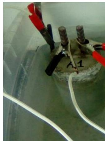
Figura 15 Celda electroquímica
