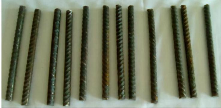
**Figura 7** Varillas de acero cortadas a una longitud de 6 pulgadas
