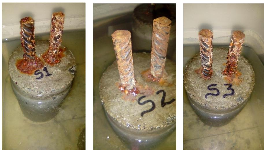
Figura 21 Resultado final de probetas sumergidas en agua con salmuera
