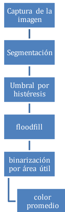
Figura 8. algoritmo del procesamiento de imágenes para obtención de características.
