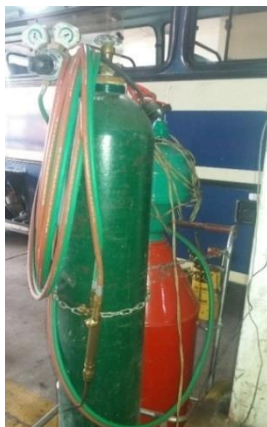
Foto 7. Equipo de soldadura autógena
