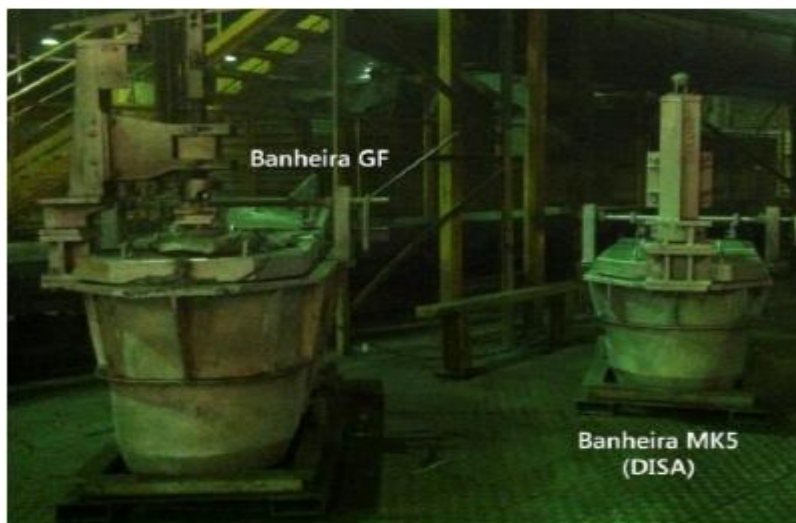
Figura 48 Exemplo de banheira de vazamento GF e Disas (A. M. M. Almeida, 2014)
