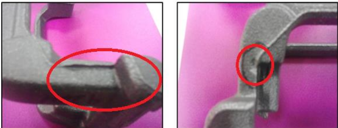
Figura 77 Exemplo de rebarba (esq.) e esmagamento (dir.)
