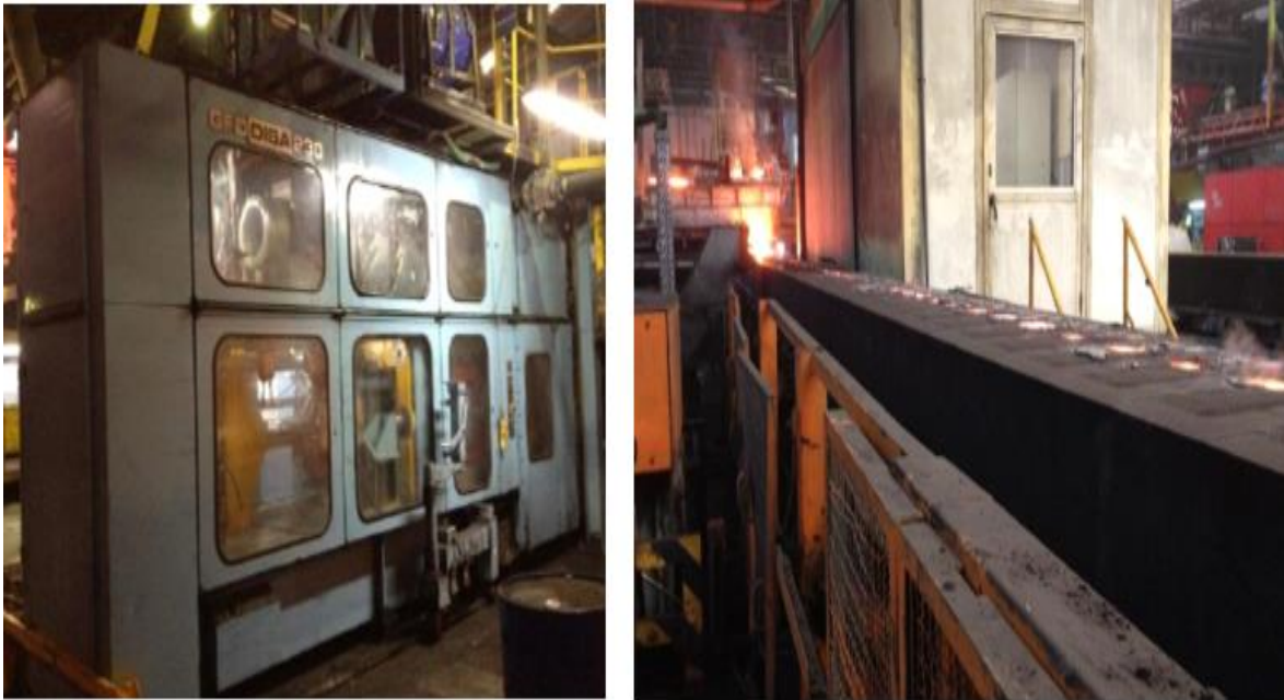
Figura 43 Máquina de moldar (esq.) e respetiva linha de arrefecimento (dir.)
