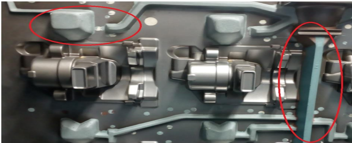
Figura 75 Exemplo de placa molde com gitagem em resina vulgar
