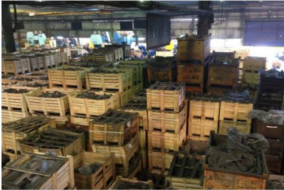
Figura 63 Excesso de WIP no armazém intermédio
