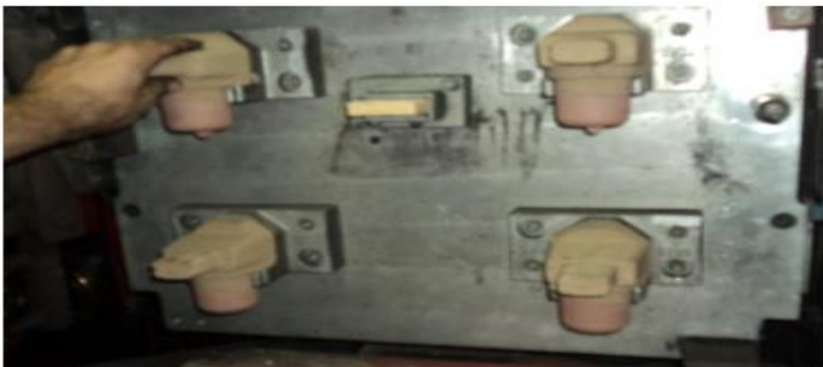
Figura 45 “Coloca-machos” e respetiva máscara
