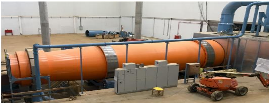
Figura 50 Exemplo de tambor rotativo e entrada na granalhadora
