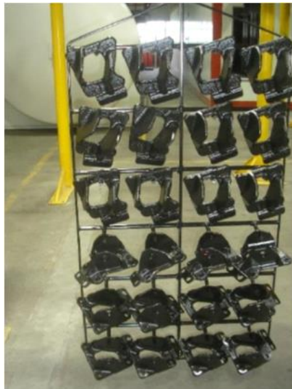
Figura 58 Componentes dispostos em bastidor de pintura (A. M. M. Almeida, 2014)
