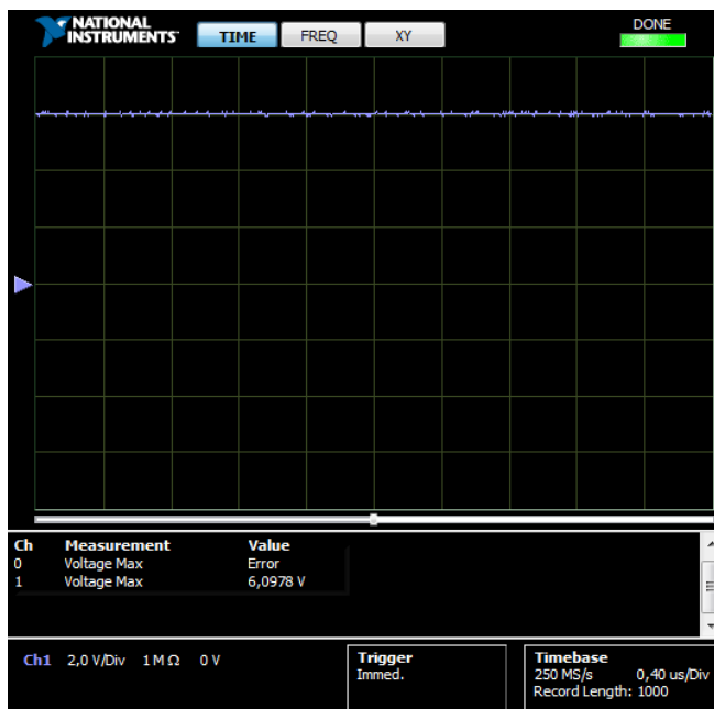
Fig. 15. Fonte CC em 6 V – Acoplamento CC – Pico: 6,0978 V.
