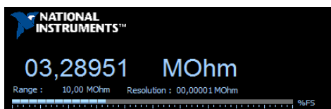
Fig. 11. Medição de resistência – R3.
