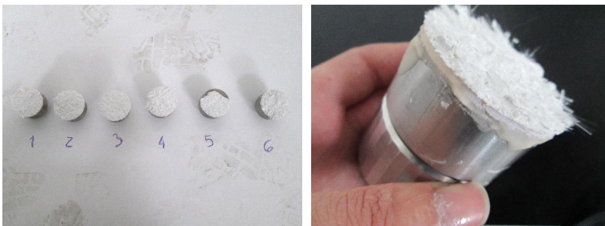
Figura 3.16 - Modos de rotura do ensaio da tração direta.
