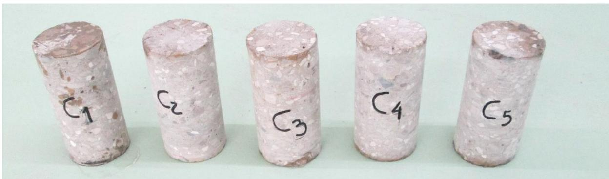
Figura 3.43 - Carotes serradas e polidas com uma relação comprimento/diâmetro 2:1.
