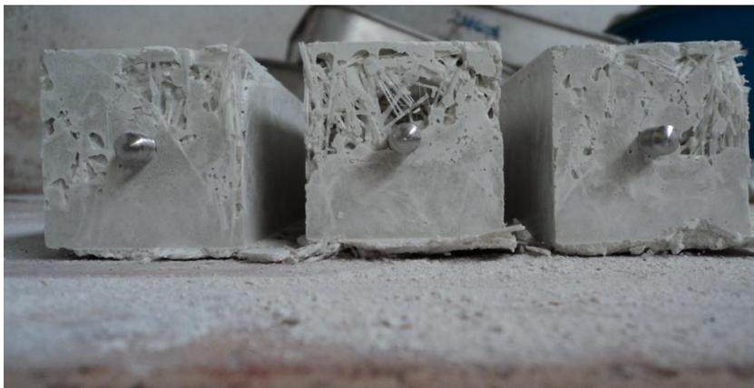
Figura 3.7 - Provete de GRC com perno de aço inoxidável.
