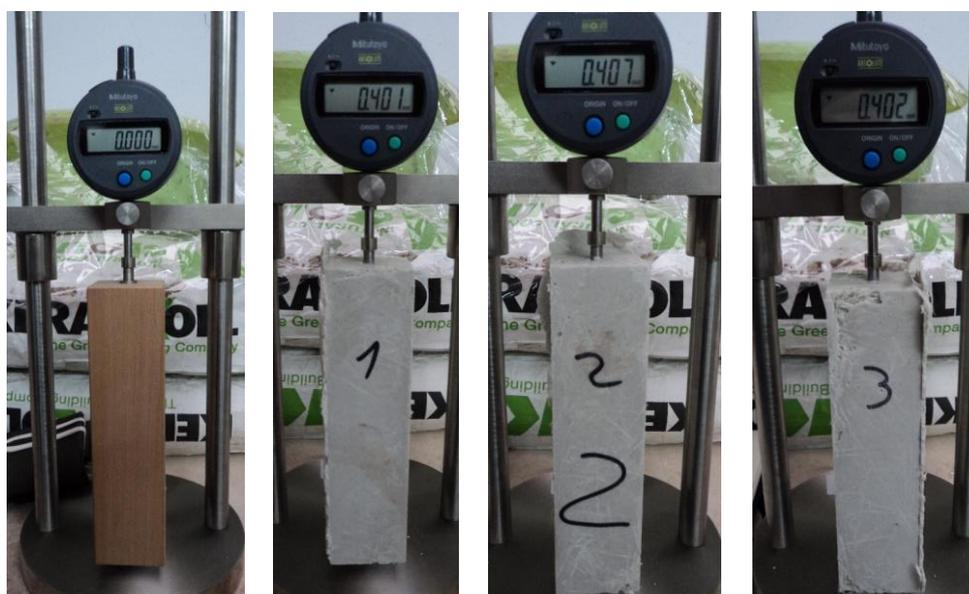
Figura 3.8 - Medição da variação de volume de provetes de GRC.
