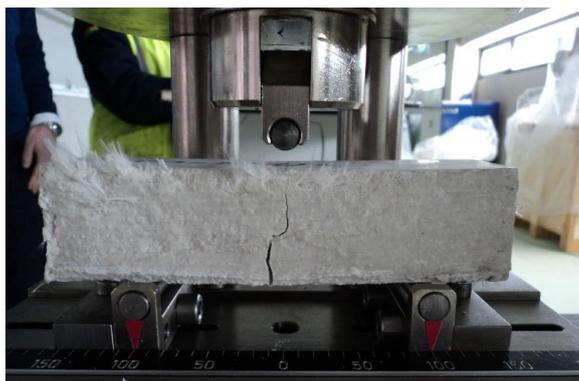
Figura 3.13 - Pós ensaio à flexão de um provete de GRC.
