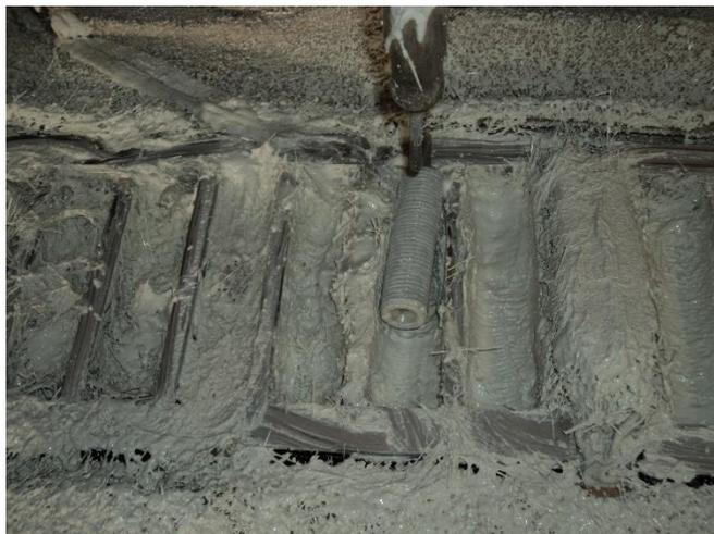
Figura 3.4 - Compactação dos provetes de GRC.
