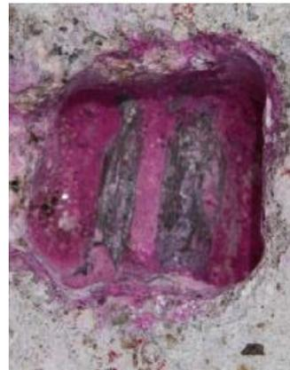
Figura 2.24 - Determinação de betão carbonatado *in situ* (Rodrigues, 2016).
