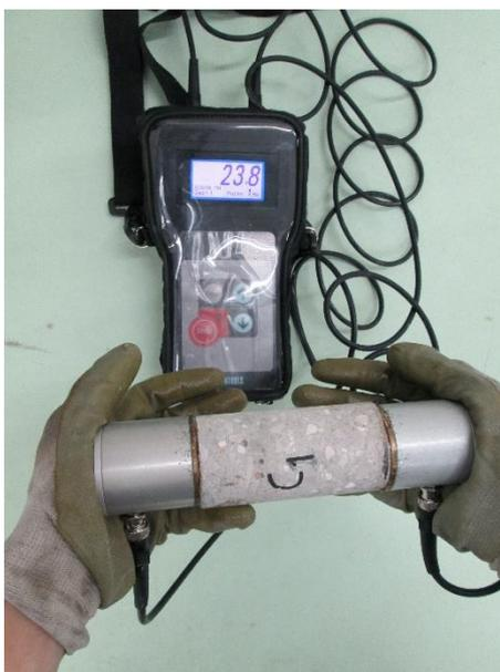
Figura 3.40 - Medição dos ultrassons na carote C1.
