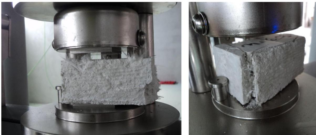
Figura 3.14 - Ensaio de determinação da resistência à compressão do GRC.
