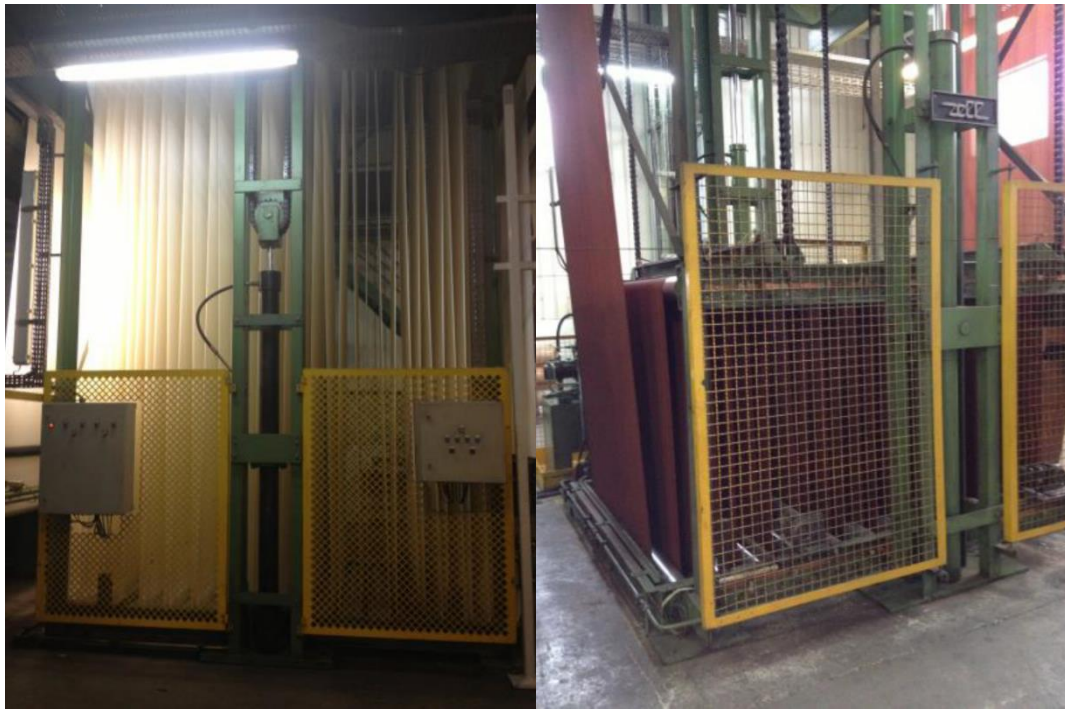
Figura 2.10. Acumulador de tela em verde (esquerda) e tela impregnada (direita).
