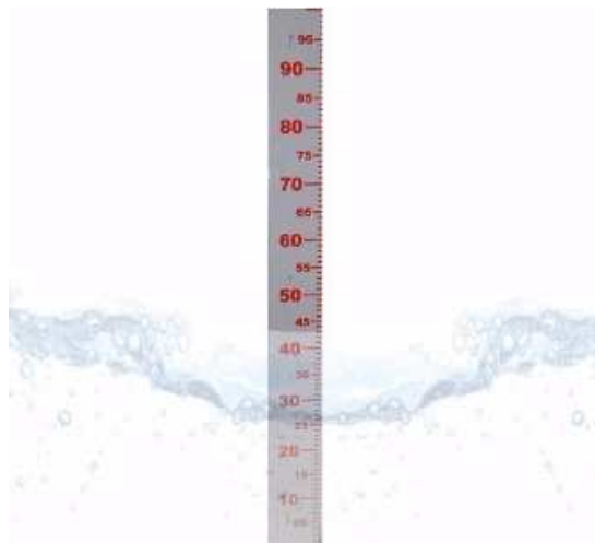
Figura 57 - Escala limnimétrica ou limnímetro (fonte: www.grupoconstruserv.eng.br ).
