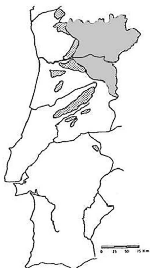
Figura 60 - Regiões pluviométricas e parâmetros das curvas IDF (adaptada de R. Matos e M. Silva, 1986).
