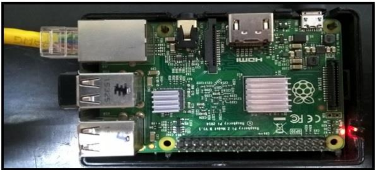
Figura 13 – Protótipo do Gateway IoT – Smart Coleira
