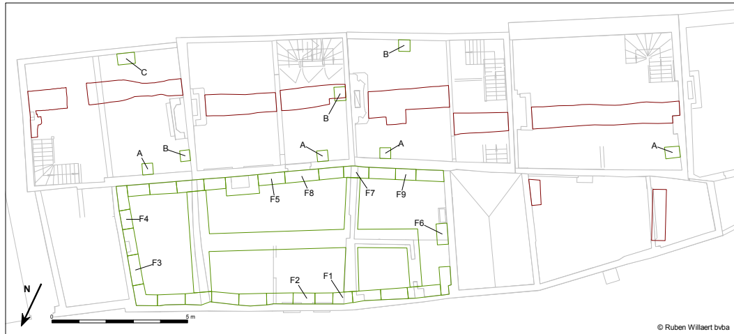
Figuur 5. Weergave van de sleuven (rood omlijnd) en de sonderingsputten en funderings sleuven (groen omlijnd)
