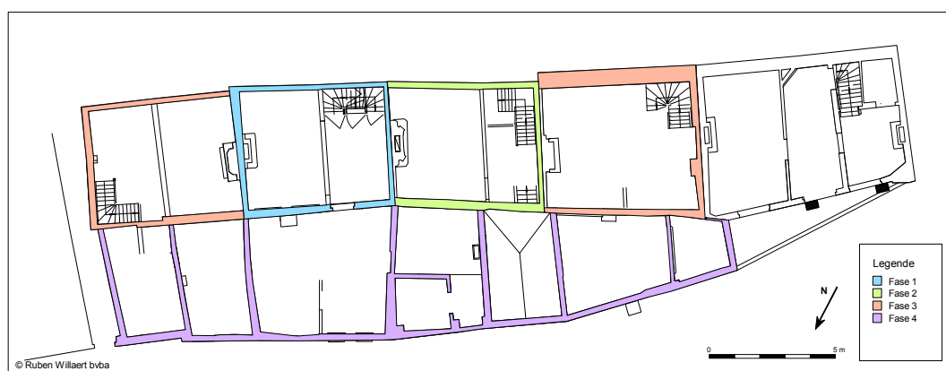
Figuur 27. Faseringsplan bouw huizenrij 37-40. De onderlinge fasering in fase 4 is onbekend.
