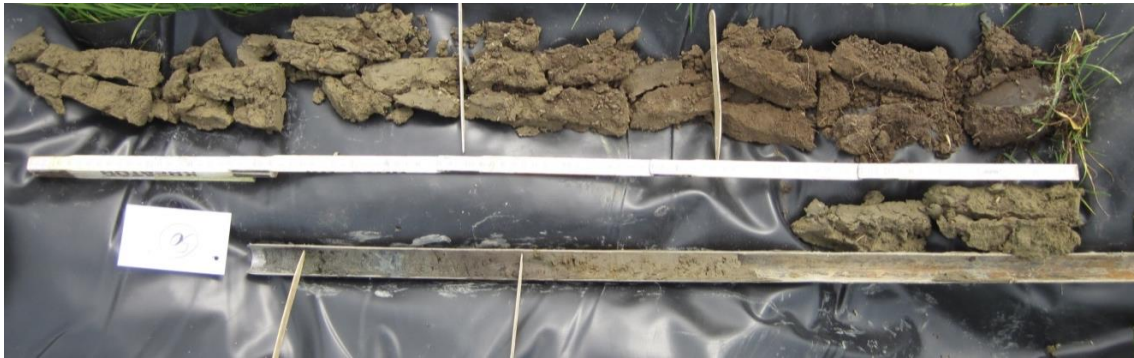
Fig.3.28 : Opgeboord sediment BR50 (rechtsboven is bovenzijde)
