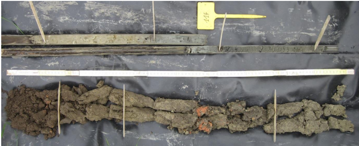
Fig. 3.19 : Opgeboord sediment BR 114 (linksonder is bovenkant)
