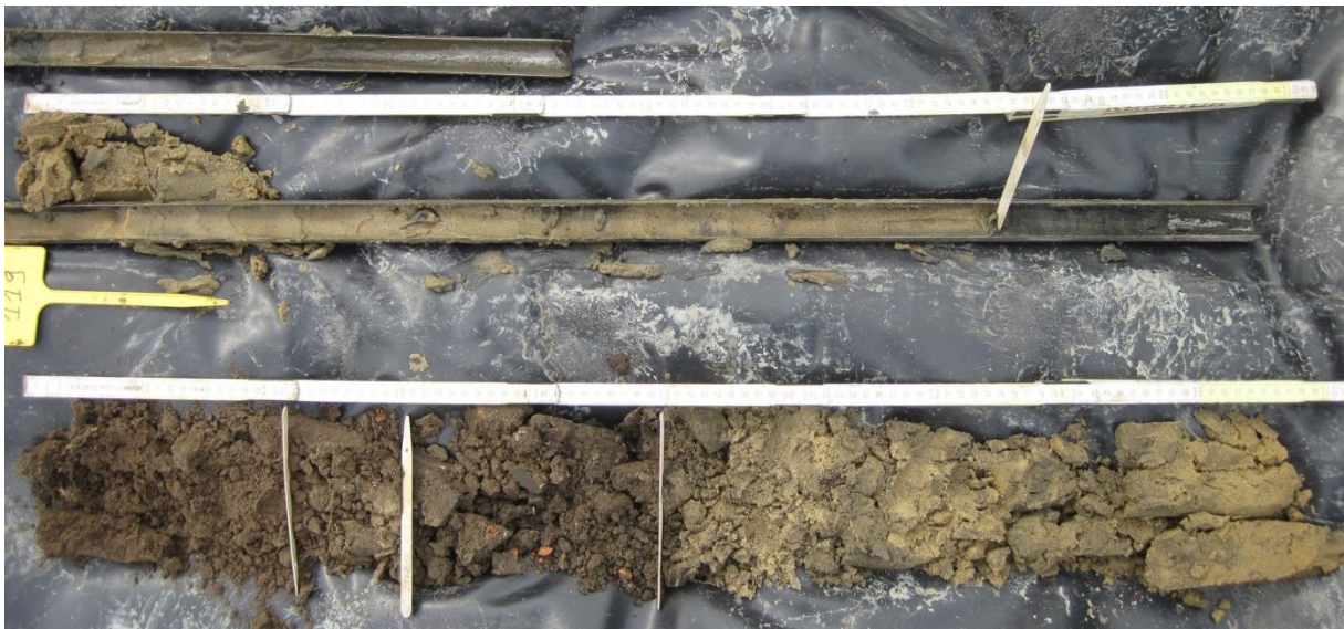
Fig. 3.20 : Opgeboord sediment BR119 (linksonder is bovenkant)
