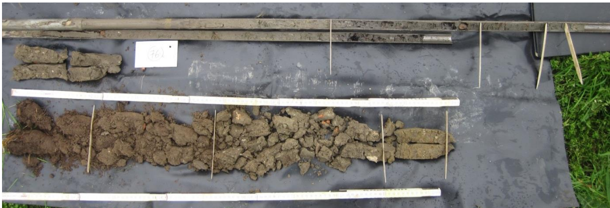
Fig. 3.37 : Opgeboord sediment BR76 (linksonder is bovenkant)
