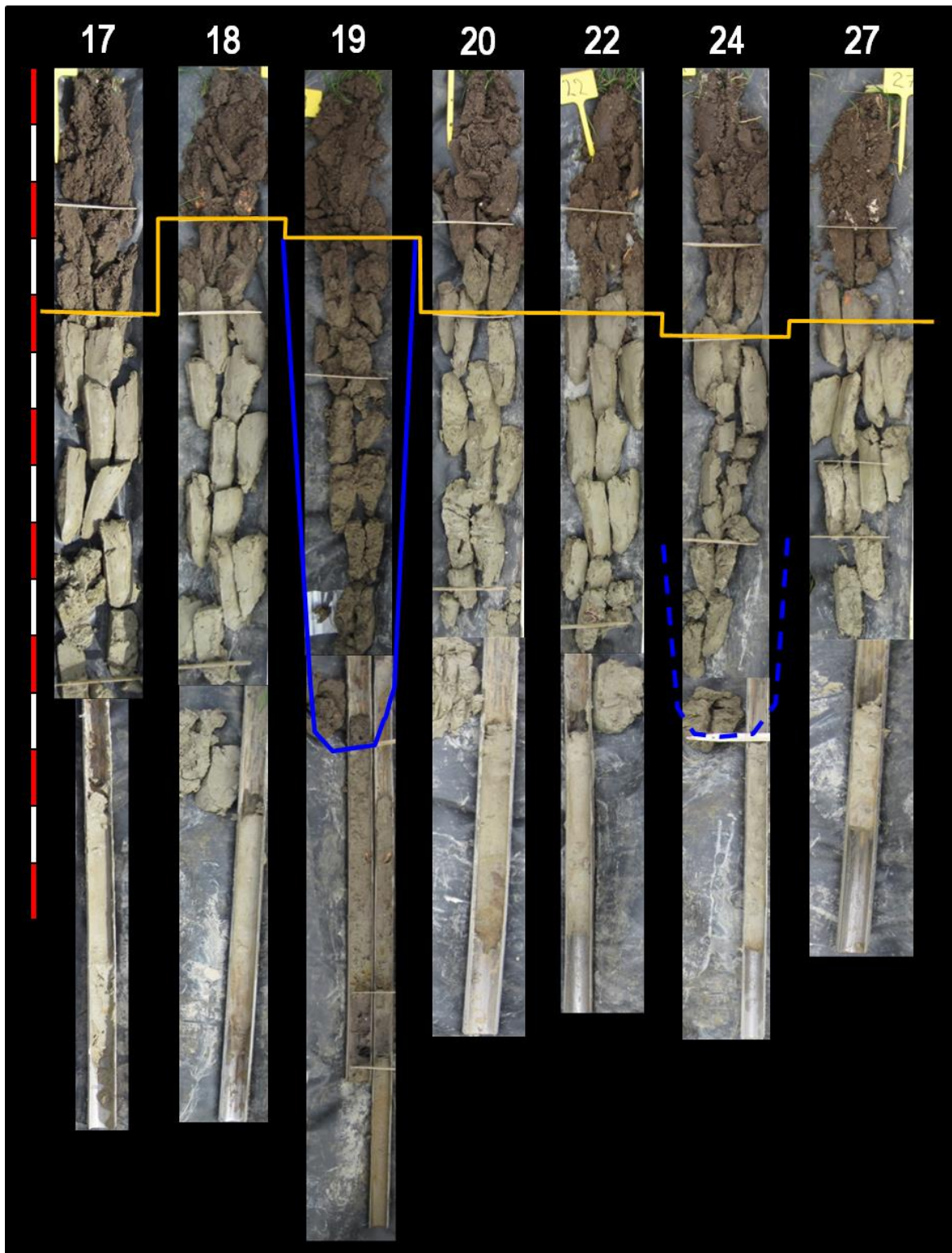
Fig. 3.32 : Boorraai 17-27. Ter hoogte van BR19 werd duidelijk een gracht aangeboord. In B24 zijn er aanwijzingen tussen 83 en 118cm van een gracht (blauwe stippellijn).
