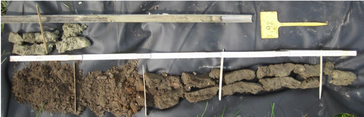
Fig. 3.42 : Opgeboord sediment BR92 (linksonder is bovenkant)
