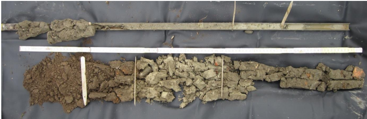
Fig. 3.38 : Opgeboord sediment BR79 (linksonder is bovenkant)
