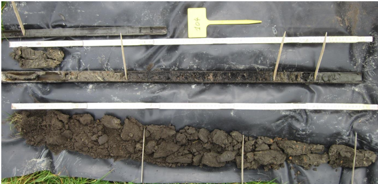
Fig. 3.15 : Opgeboord sediment BR 104 (linksonder is bovenkant)
