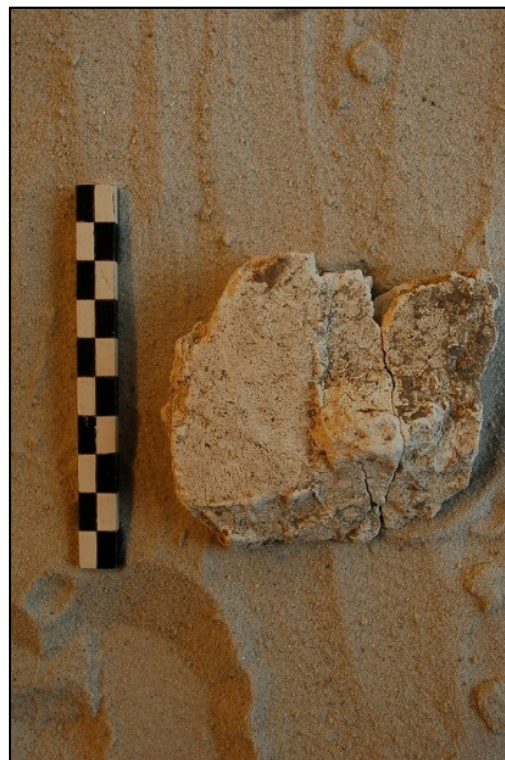
Fig. 30: achterzijde van het beschilderd pleisterwerk met indrukken van latje, plankjes en twijgjes.
