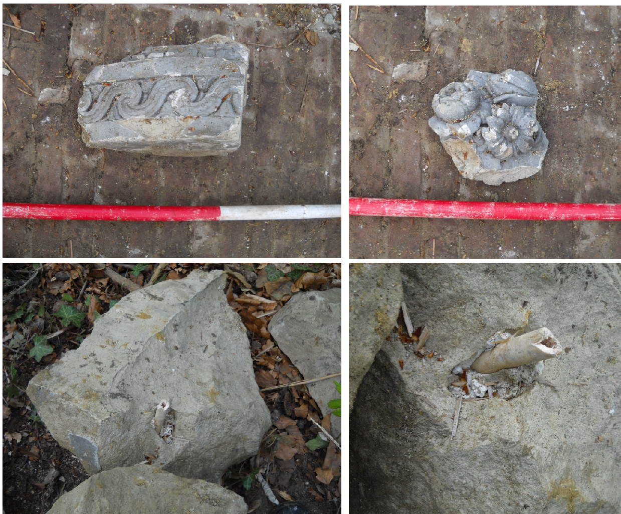
Figuur 16. Fragmenten van ornamenten in natuursteen van het paviljoen, ingezameld uit het puin in de ijskelder. Sommige ornamenten waren aan elkaar bevestigd d.m.v. botjes en kalkmortel (herstelling?). (Foto's Triharch)
