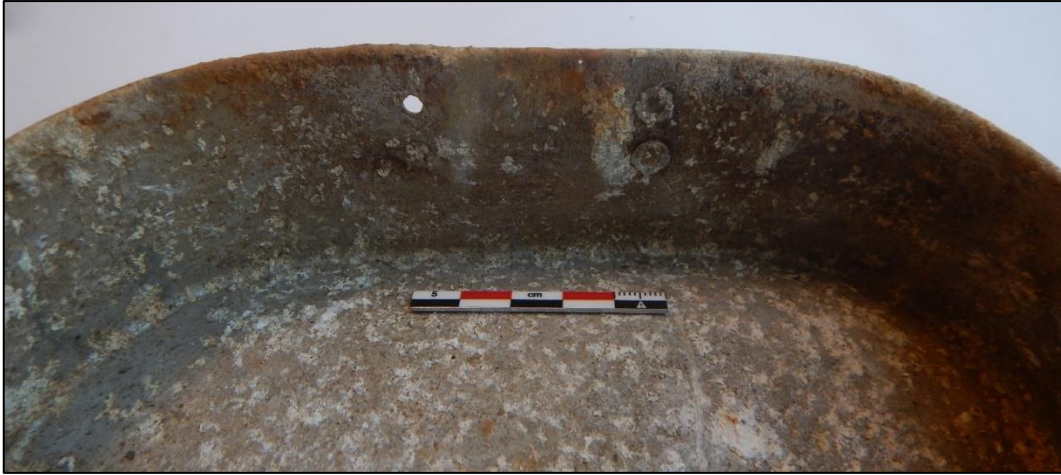
Figuur 109: Opname van de binnenzijde van het deksel van een eetketel model M 1896 met de beugelhechtingen voor de eetlepel duidelijk zichtbaar.
