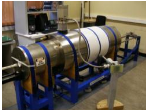
Figuur 2: cryogene magnetometer van 2G Enterprises voor meting van de remanente magnetisatie van grote stalen.
