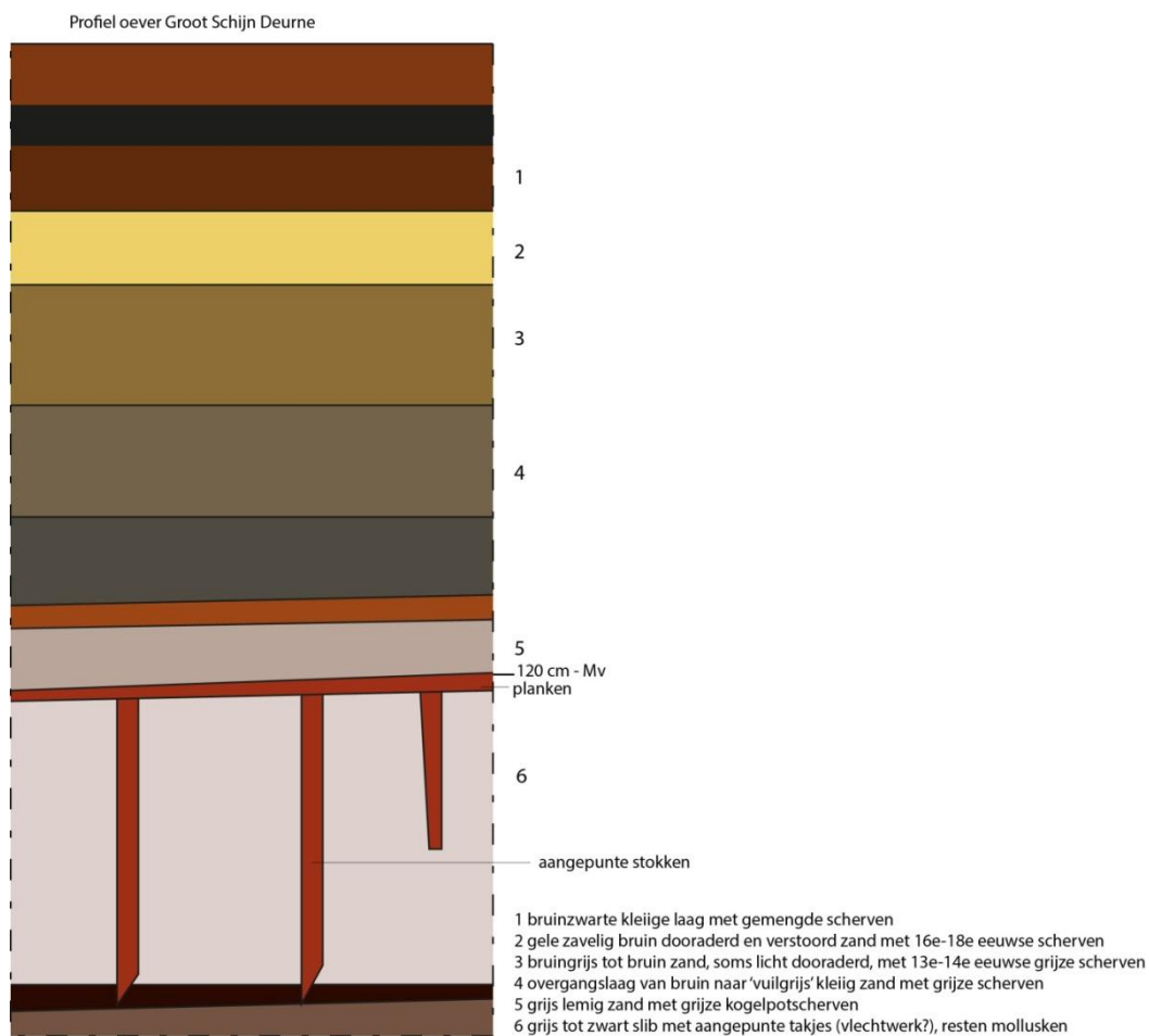
Figuur 17: Gedigitaliseerde versie van het profiel van de oever van het Groot Schijn ter hoogte van de opgraving 'Hoeve Achter de Kercke' te Deurne. Schematische weergave van potloodtekening uit het verslag van de opgravingscampagnes in de jaren 1975 – 1980 van de heemkundige kring Turninum Deurne.
