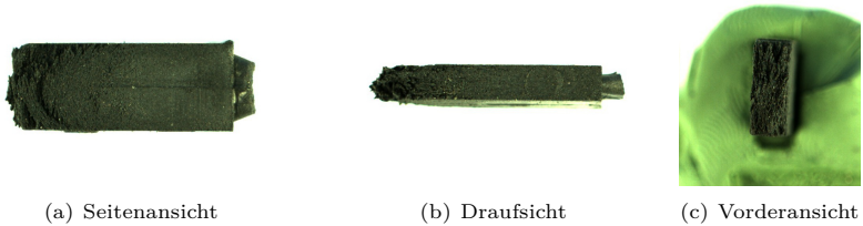
Abbildung A8: Füllstudie des Compounds PA12 + 65 Vol.-% MQA (L1); Kavität: Variante 2; mit Richtfeld
