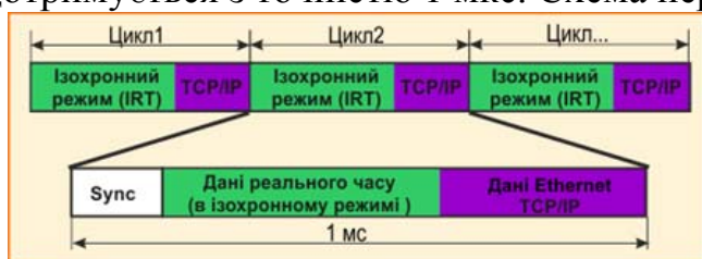
Рис. 4. Організація обміну даними в PROFINET IRT
