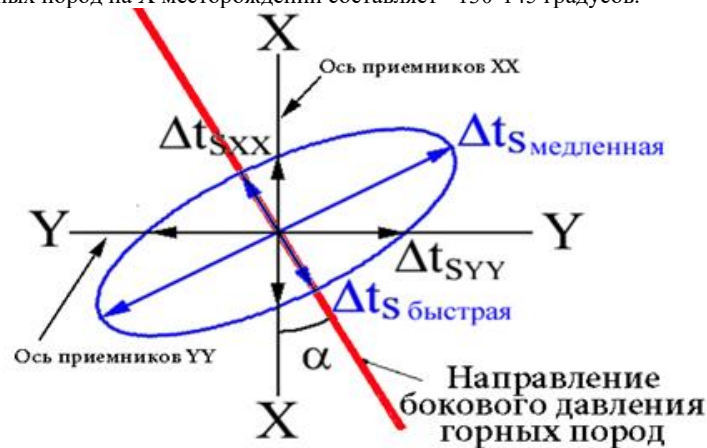
Рис. 2 Результаты проведения исследования АВАК на X месторождении, где: \alpha – угол скоростной анизотропии относительно направления прибора XX, SF – быстрая поперечная волна, SS – медленная поперечная волна, SXX – зарегистрированная поперечная волна в направлении XX, SYU – зарегистрированная поперечная волна в направлении YY
