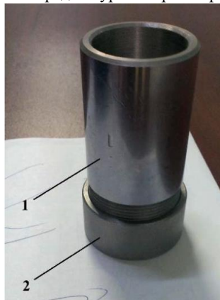
Рис. 1 – Цилиндрический стакан для исследований: 1 – стакан, 2 – крышка-зажим
