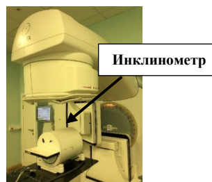
Рис. 4- Фантомная установка OCTAVIUS4D на Elekta Infinite в ЛРЦ г. Москва
