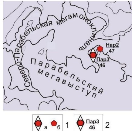
Рис. 1 Положение моделируемых скважин на Парабельском мегавыступе (на основе [5] с дополнениями): 1 – моделируемые скважины с использованием геотемператур: а) пластовых, полученных при испытании скважин, снятых с картажных диаграмм ОГГ и пересчитанных из ОСВ, б) снятых с картажных диаграмм ОГГ; 2 – моделируемая скважина: в числителе – индекс на карте, в знаменателе – расчетный тепловой поток
