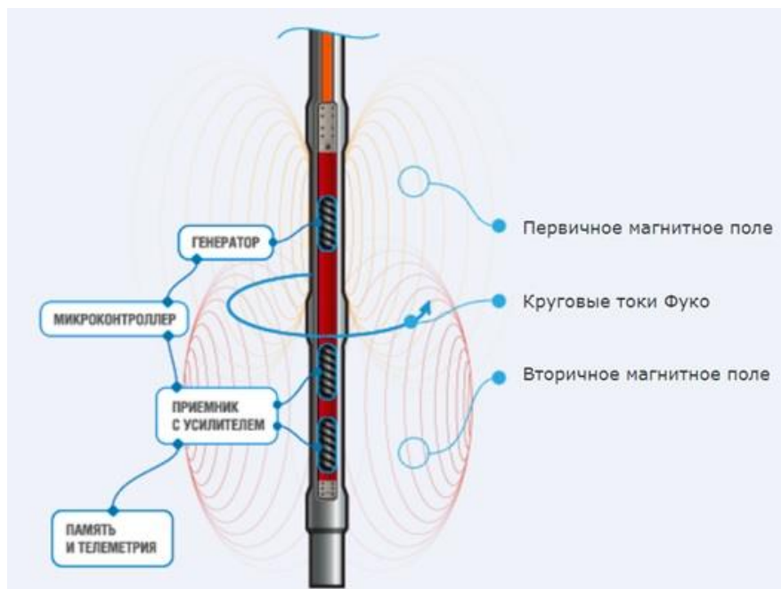
Рис.1 Принцип измерения сопротивления ГП
