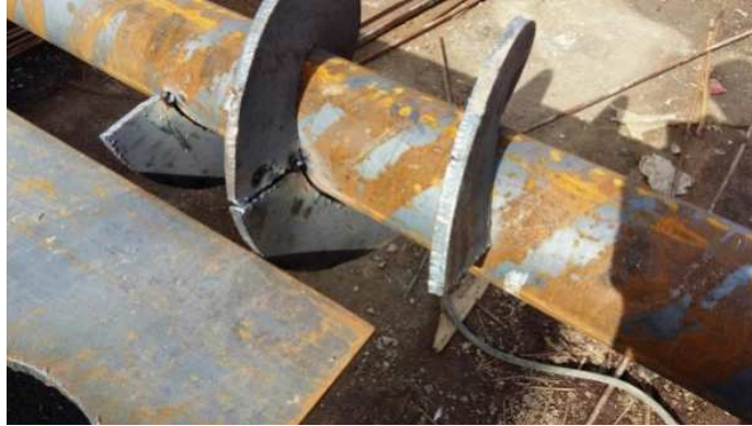
Рис. 2. Дефекты шнека - разрывы
