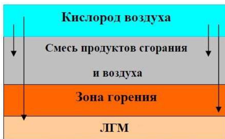
Рисунок 10 - Диффузия кислорода в зону горения ЛГМ (гетерогенное горение)
