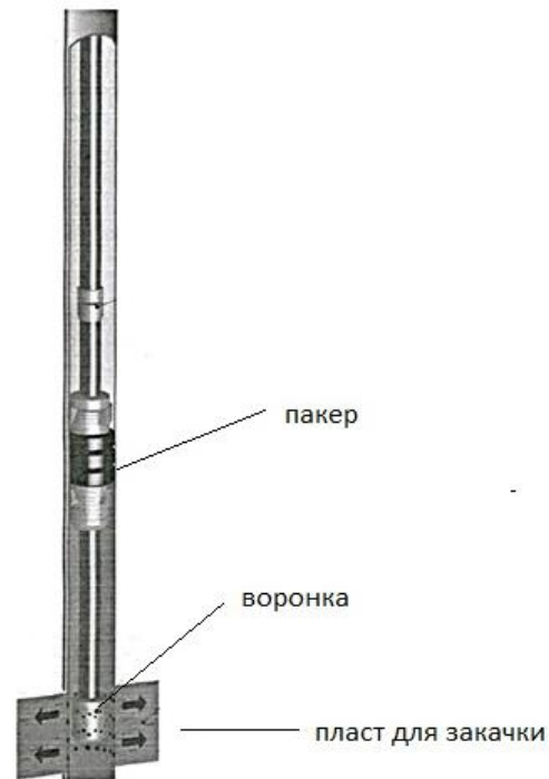
Рисунок 3.20 - Схема подземного оборудования нагнетательной скважины
