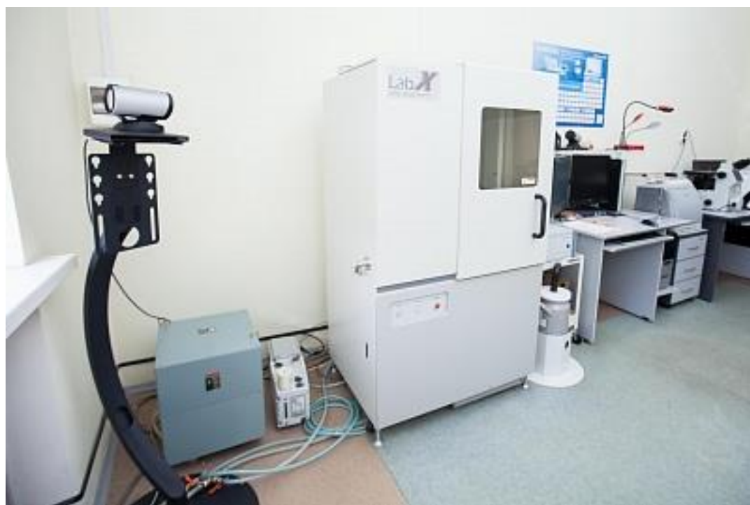
Рисунок 9– Дифрактометр Shimadzu XRD-6000
