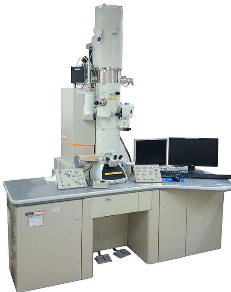
Рисунок 8 – Просвечивающий дифракционный электронный микроскоп JEM-2100F JEOL
