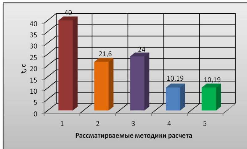
Рисунок 2.3 – Расчетные данные времени существования ОШ по различным методикам (1 – ГОСТ Р 12.3.047-98; 2 – ГОСТ Р 12.3.047-2012, 3 – СТО Газпром, 2009; 4 – Методика оценки ПБР ФЦНС, 2016 (без учета ослабления атмосферой); 5 – Методика оценки ПБР ФЦНС, 2016 (с учетом ослабления атмосферой))
