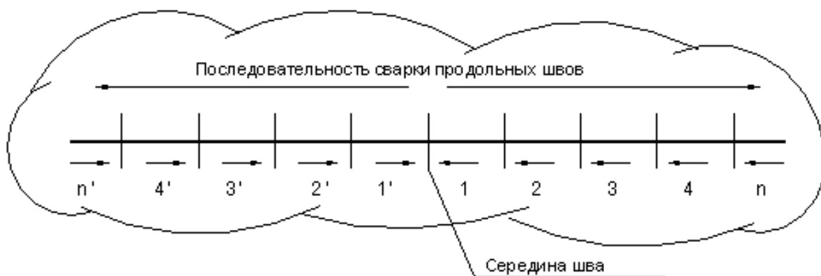
Рисунок 3 – Схема последовательности наложения сварных швов
