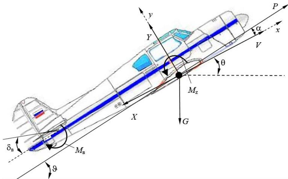
Рисунок 15 – К выводу уравнений продольного движения ЛА
