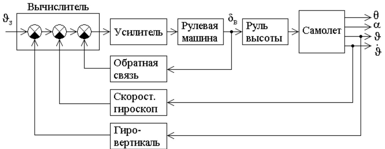
Рисунок 17 – Функциональная схема канала тангажа со скоростной обратной связью
