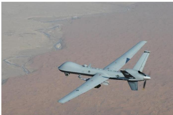
Рисунок 6 – БПЛА MQ-9 Reaper
