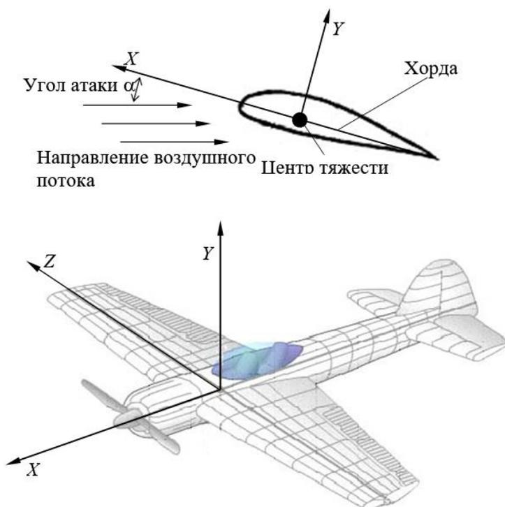
Рисунок 9 – Связанная с ЛА система координат
