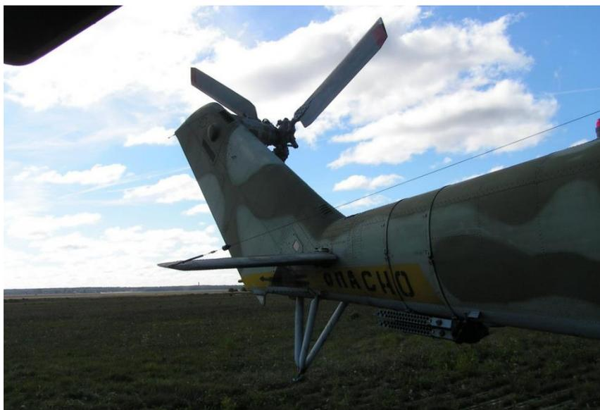
Рисунок 4 – Рулевой винт вертолета Ми-8
