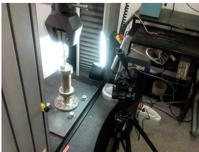
Рисунок 17 – Камера производит съемку в процессе нагружения образца
