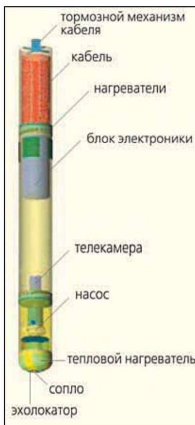
Выкипировка из [4]. Рисунок 2– общий вид крибота
