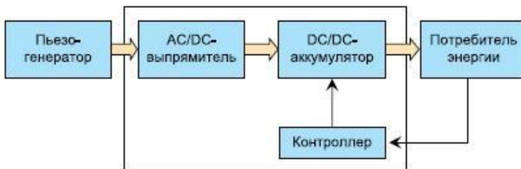
Рисунок 1 - Схема преобразователя механической энергии в электрическую энергию.
