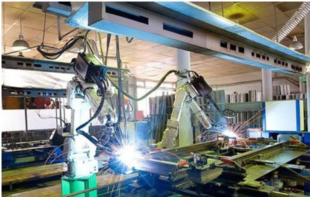
Рисунок 3.2 – Сварочные роботы на автоматизированной линии
