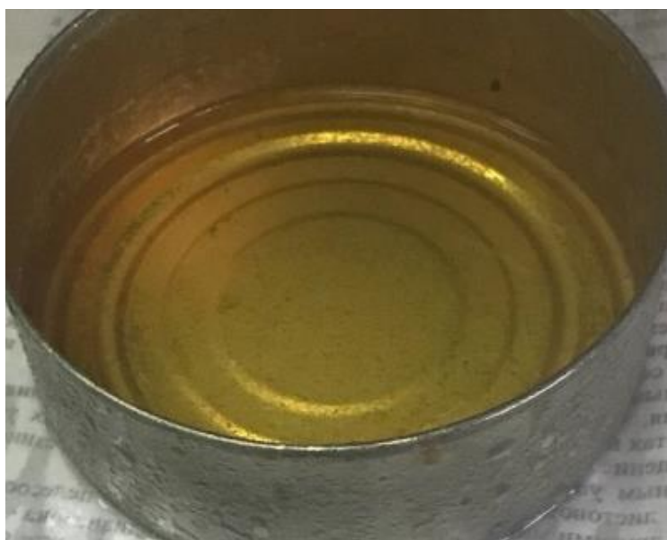
Рисунок 2.3 – Подготовленная ёмкость с ацетоном и водным раствором жидкого стекла
