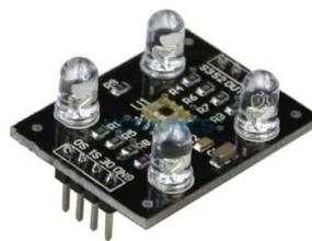
Рис.4. Датчик определения цвета объекта
