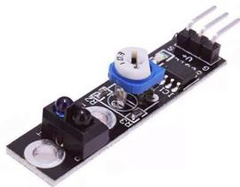
Рис.3. Датчик контроля линии
