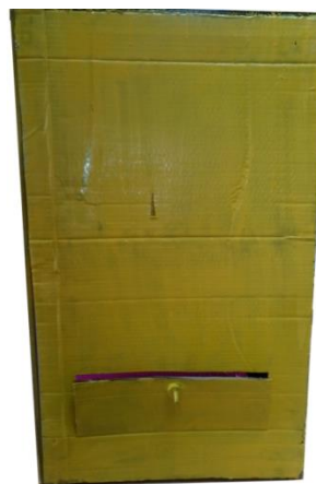
Рис. 4. Задняя стенка контейнера с разгрузочным люком
