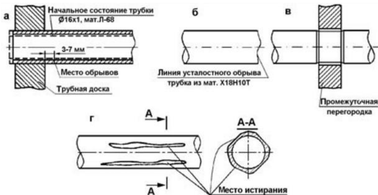
Рисунок 3 – Характерные следы износа теплообменных трубок регенеративных подогревателей [5]
