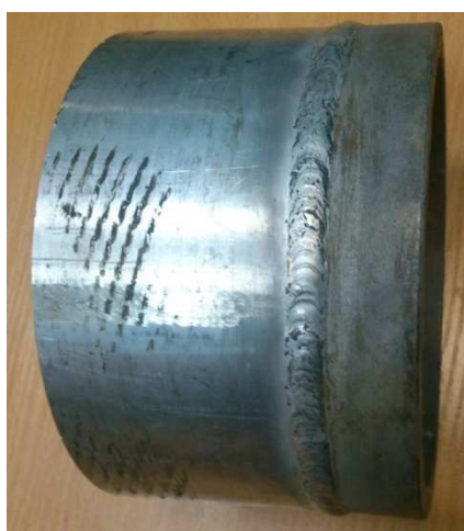
Рис. 2. Внешний вид моделей переходников
