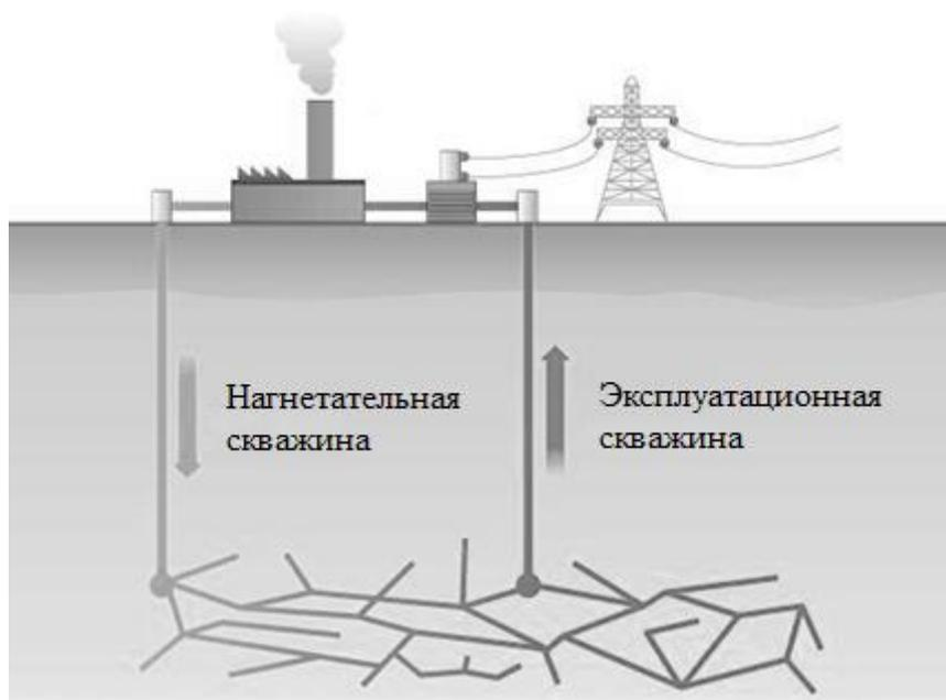
Рис. 1. Схематичное изображение петротермальной станции на HDR-технологии
