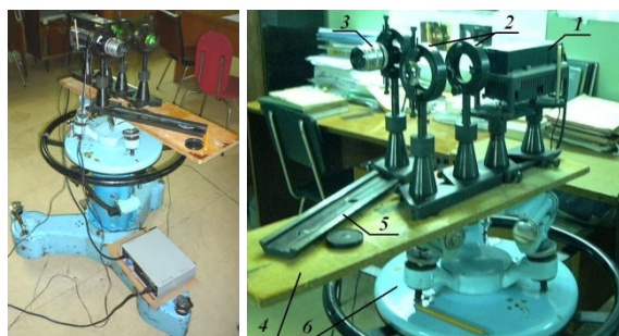
Рис. 1. Общий вид оптико-электронного узла: 1 – лазер LCS-DTL-317-50; 2 – расширитель пучка; 3 - телекамера; 4 – рабочий стол; 5 – оптическая линейка; 6 – подвижный телевизионный штатив
