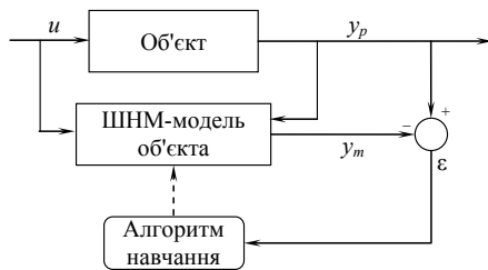
Рис. 3. Схема навчання нейронної мережі прогнозуючої ШНМ-моделі
